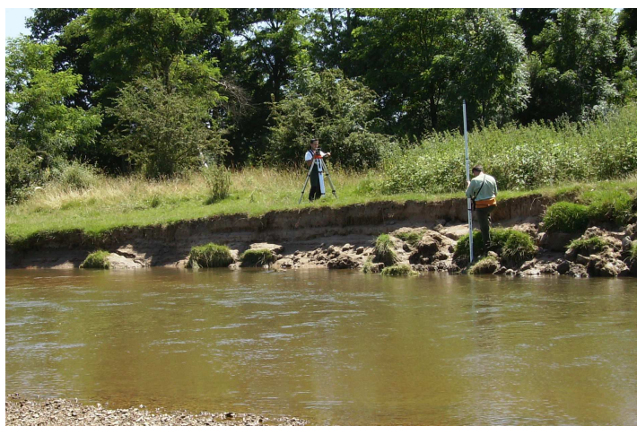
Figure 16 : mesure de la hauteur de berge gauche à la mire et au niveau sur un transect (station RHP de Dompierre-sur-Besbre) (cliché personnel)
