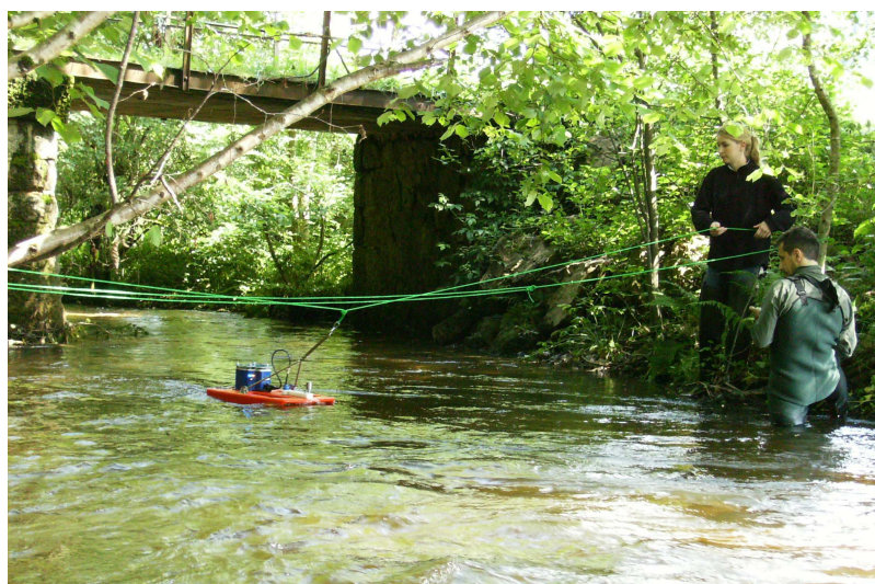
Figure 14 : traversée du débitmètre sur un plat courant de la Besbre amont (station RHP de La Chabanne) (cliché personnel) ; acquisition des données en temps réel avec le logiciel StreamPro et archivage des différents passages réalisés [Teledyne RD Instruments, 2006]
