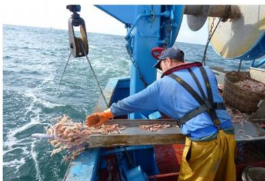
Dispositifs de goulotte/glissière : posé sur la lisse tribord (Roxy, 2015, Aglia)
