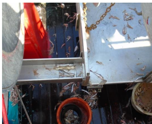
Dispositifs de goulotte/glissière : posé sur la lisse tribord (Kreiz an aod, 2016, Aglia)
