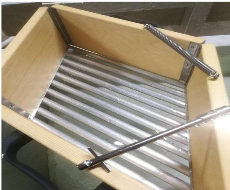
Figure 14: Trieur à barreaux (réglé à 13mm) (photo personnelle).
