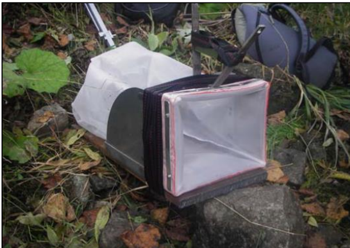
Figure 3 : Filet Surber utilisé pour l'étude de la dérive des invertébrés sur la Creuse en 2008 (ECOGEA, MEP 19, 2008)
