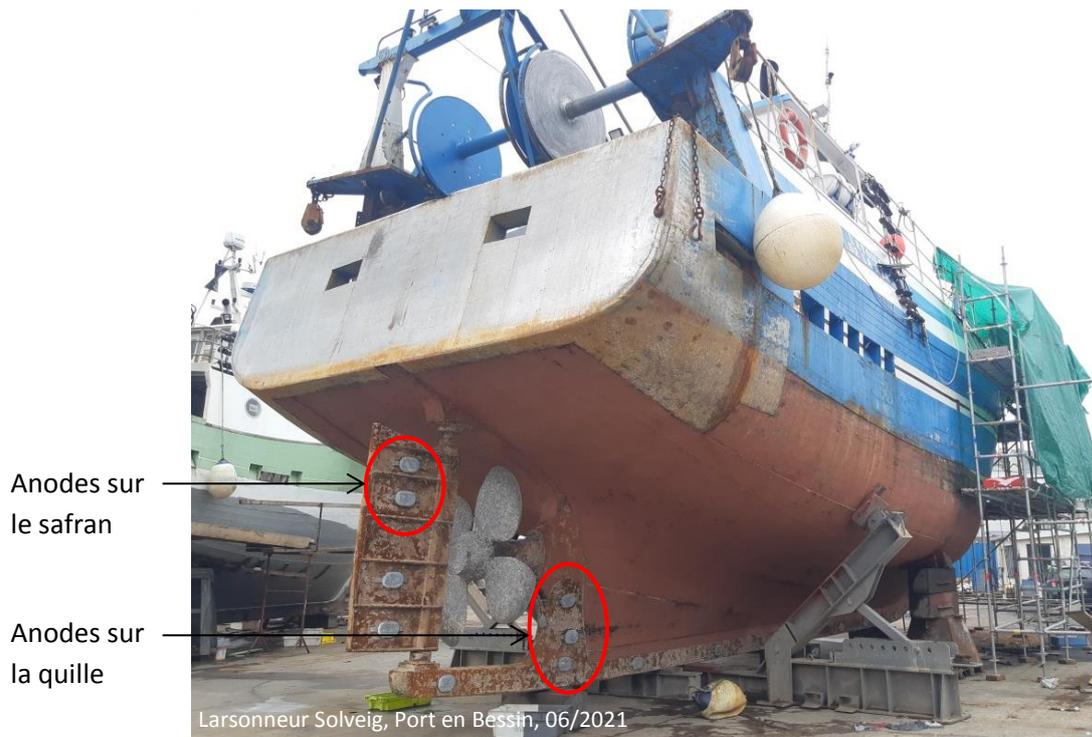
Figure 7 : Emplacement des anodes galvaniques sur un navire de pêche.
