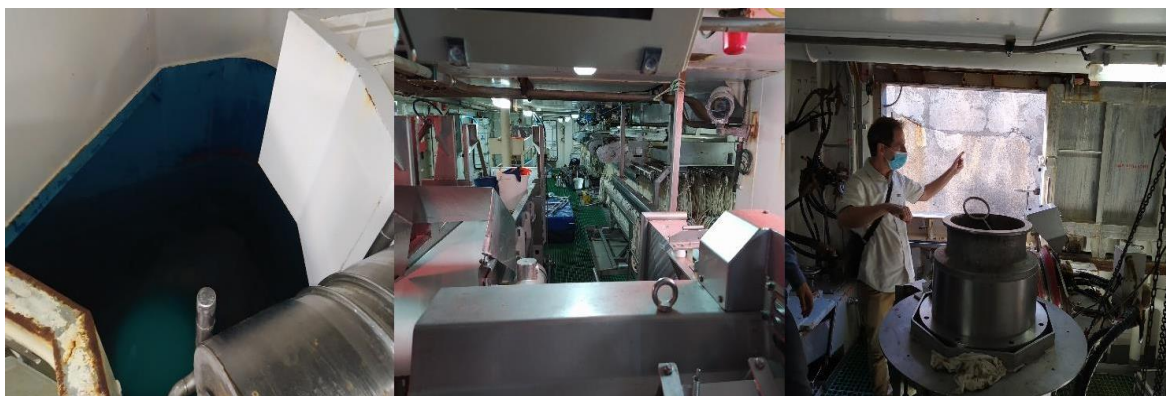
Figures 2.a) à 2.c) Photographies personnelles du palangrier de fond « Cap Kersaint » visité le 14 juin 2021 : 2.a) Moon-pool permettant de remonter les captures en sécurité. 2.b) Rampe arrière de filage 2.c) Treuil vireur pour relever les orins et lignes sur bords.
