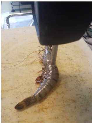
Figure 4 : crevette crue positionnée sous le texturomètre
