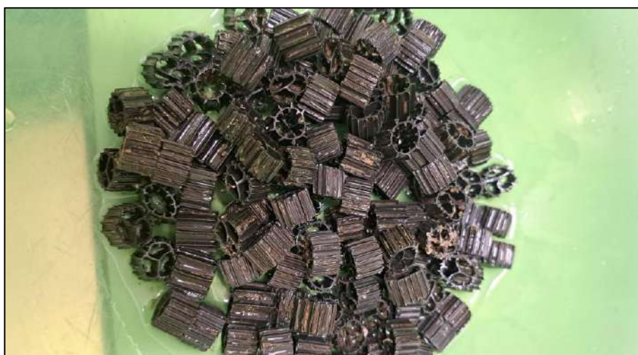
Figure 2. Photographie des bio-balles utilisées (source personnelle, laboratoire UGeRAA le 15/06)
