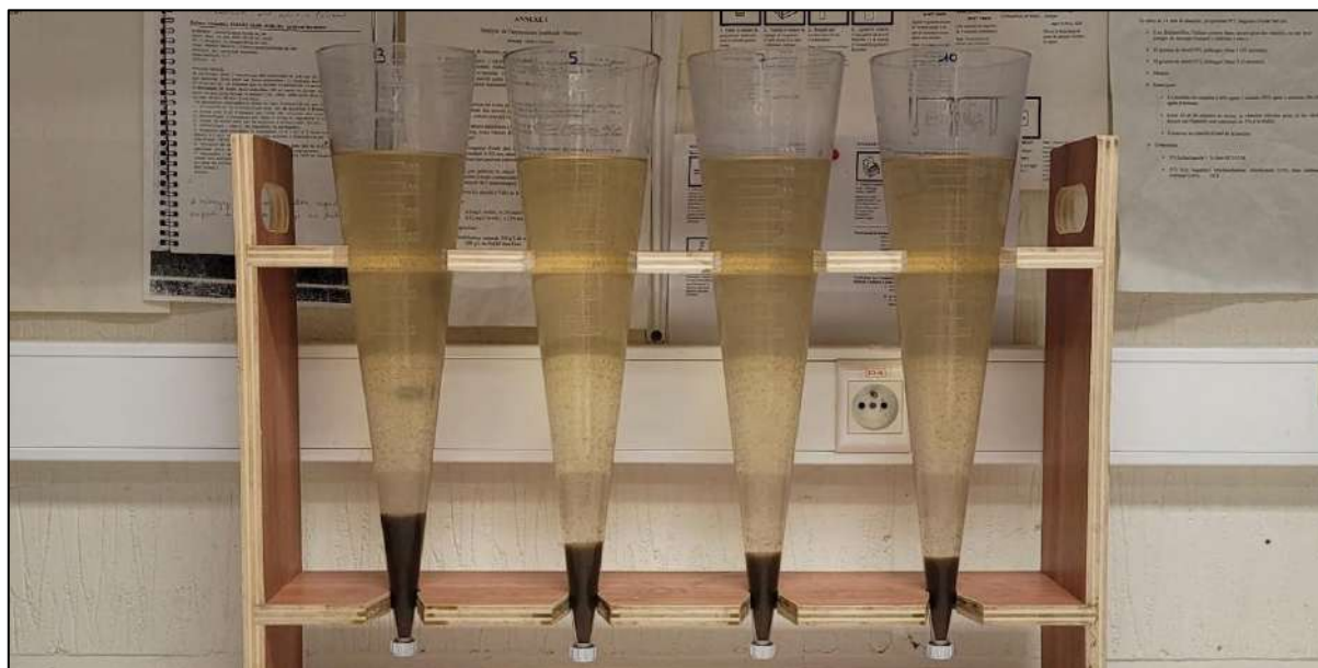
Figure 5. Photographie de l'outil de mesure (cônes Imhoff) de la concentration en solides décantables (source personnelle, laboratoire UGeRAA le 11/06)
