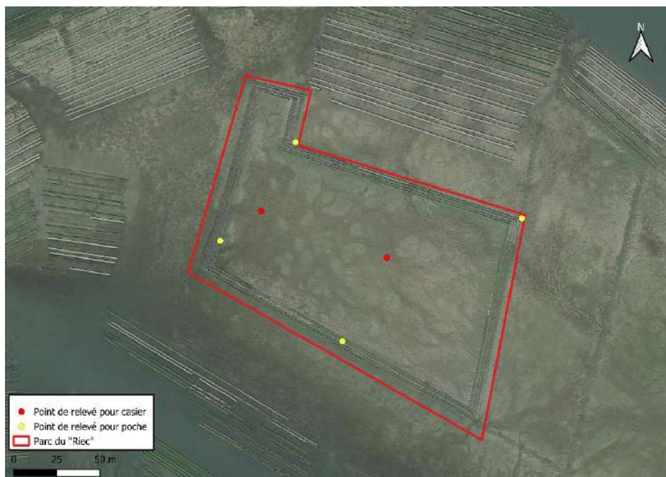
Figure 5 : Localisation des points des relevés de hauteur d'eau sur le parc du Riec (d'après Google Earth, 2024)
