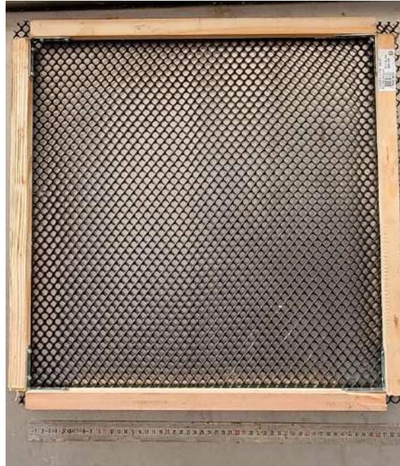
Figure 8 : Tamis réalisé avec une poche de maille 9 mm (source : Pierre Cochenne, 2024)
