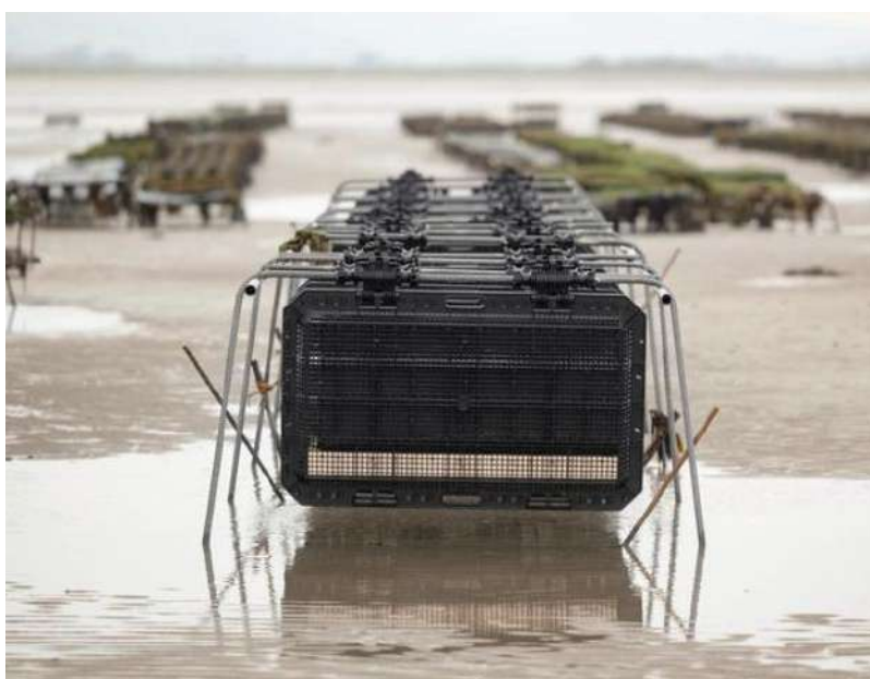
Figure 3 : Casiers marée-moteurs Roll'Bags installés sur parc (source : GrainOcéan International, 2023)
