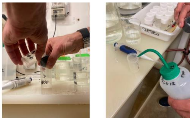
Figure 2 Filtration des piluliers à 0.2 \mu avec récupération de l'eau, puis rinçage à l'eau de mer
