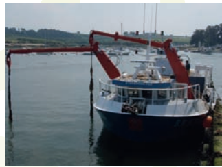
(2) Goémonier utilisé pour la récolte de Laminaria digitata sur les côtes du Finistère en France, © Maguire.
