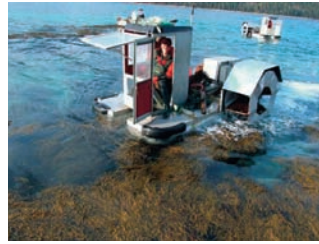
(3) Embarcation munie d'une roue à aubes coupantes, utilisée pour la récolte d' Ascophyllum nodosum en Norvège, © Sander.
