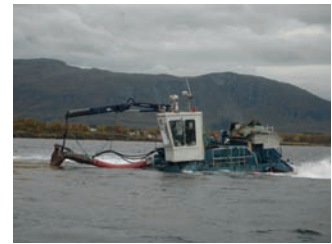
(4) Embarcation munie d'un système de coupe puis d'aspiration, utilisée pour la récolte d' Ascophyllum nodosum en Norvège, © Rebours.
