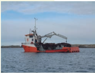
(1) Navire muni d'un peigne norvégien, utilisé pour la récolte de Laminaria hyperborea en Norvège © Bioforsk.
