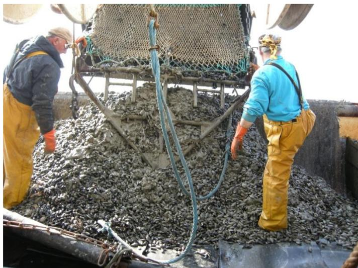
Figure 2 : Drague à moule (photo : CRPMEM de Basse-Normandie)
