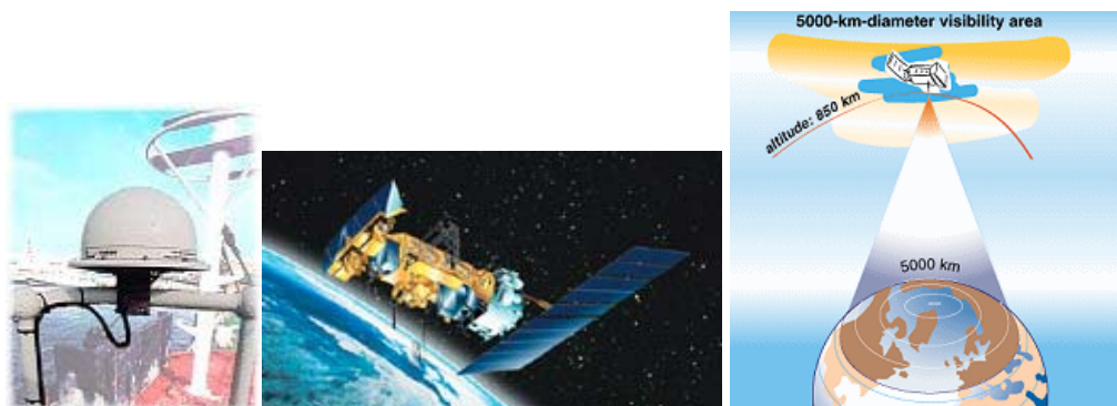
Figure 63. Quelques éléments du système VMS : Balise Argos embarquée à bord d'un navire de pêche (à gauche); Satellite de la NOAA à orbite polaire (au centre) et diamètre de sa zone de visibilité, à droite. Source : www.cls.fr .
